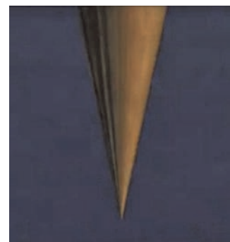
Pointe de balayage d'un microscope à effet tunnel
