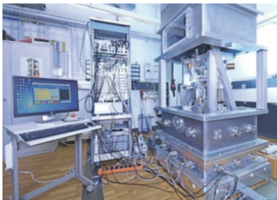
La balance de KIBBLE construite en Suisse pour mesurer la constante de PLANCK avec une très grande précision
